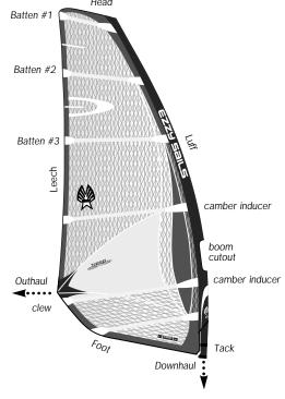
SLIDE MAST IN SLEEVE —— OUTHAUL —— SNAP CAMS ON MAST —— DOWNHAUL —— TENSION CAM BATTENS
